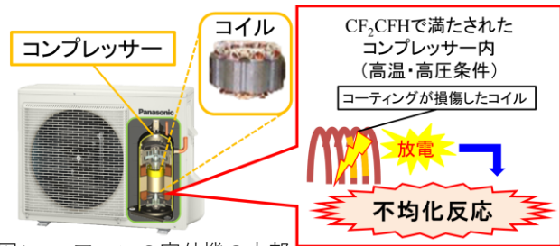
図1 エアコンの室外機の内部
